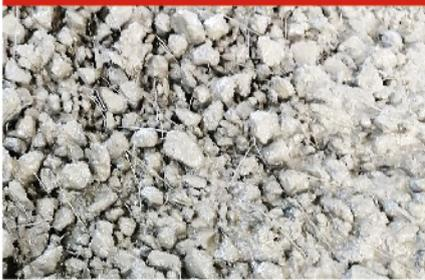
**BUNDREX 65/35CH** 강섬유는 슛크리트 보강용으로 설계된 고품질 구조용 강섬유입니다. EN14651 및 ASTM1609 표준에 따른 실험실 테스트를 통해 입증된 우수한 성능으로 터널 보강용 와이어메쉬를 완벽하게 대체가능합니다.
